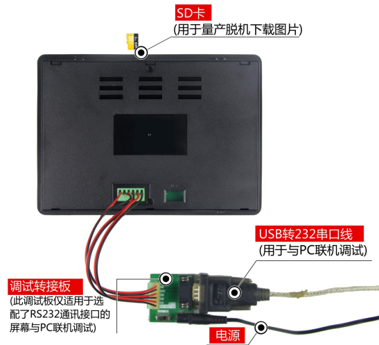
图 1-3 RS232 调试工具图
