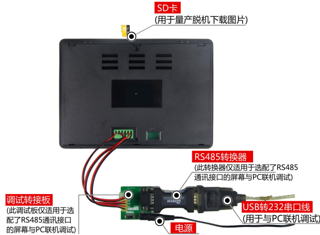
图 1-4 RS485 调试工具图
